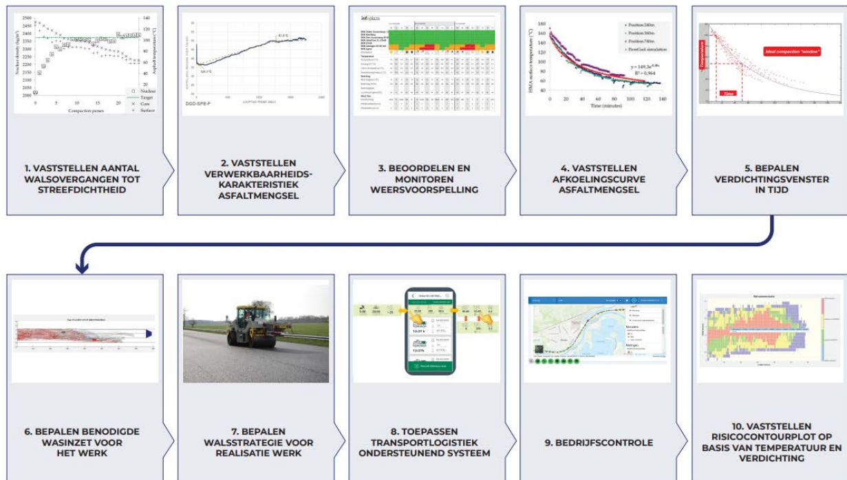
Figuur 6, het Boskalis '10-stappen plan' voor perfecte asfaltverwerking
